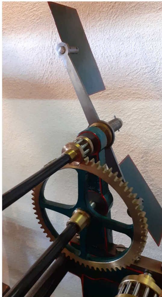
Abbildung 448: Turmuhr Zachariä, Windflügel
