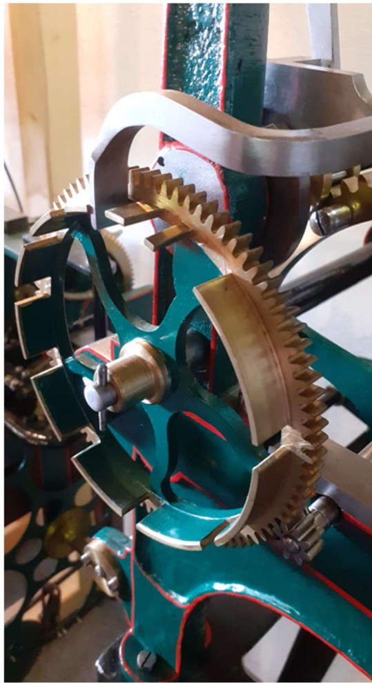
Abbildung 446: Turmuhr Zachariä, Schlossscheibe Stundenschlagwerk
