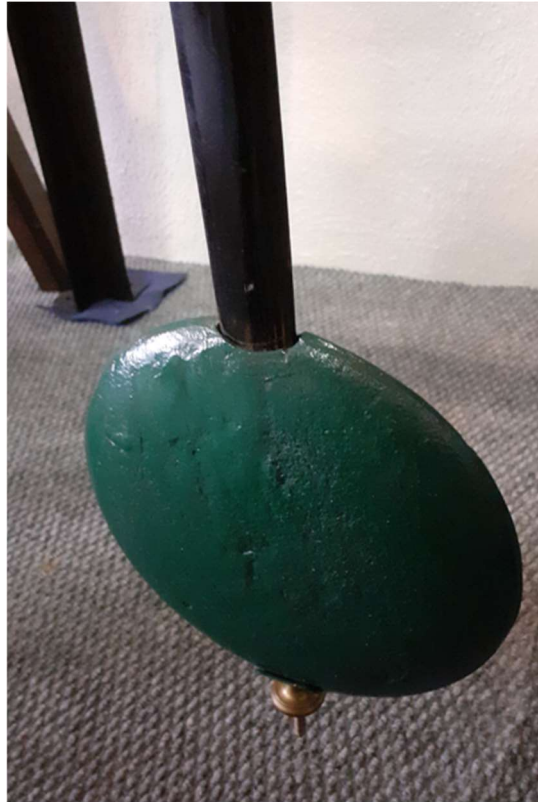
Abbildung 443: Turmuhr Zachariä, Pendellinse
