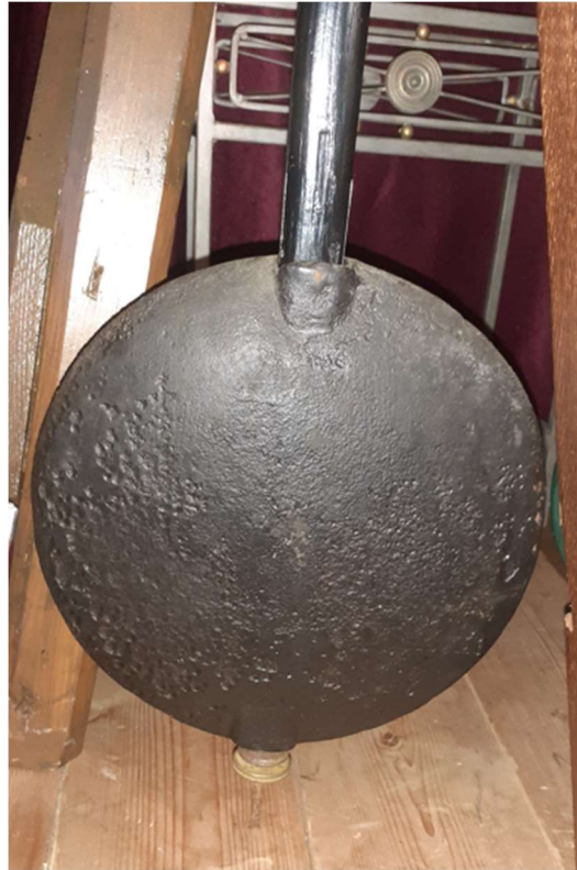
Abbildung 492: Turmuhr Handke, Pendellinse
