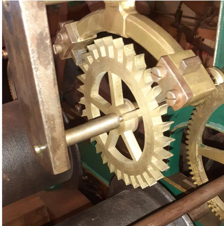
Abbildung 488: Turmuhr Handke, Gehwerk, Graham-Hemmung
