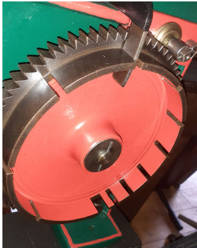
Abbildung 463: Turmuhr Jähler, Schlossscheibe
