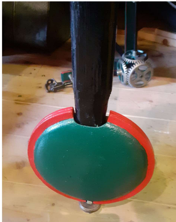
Abbildung 458: Turmuhr Jähler, Pendellinse
