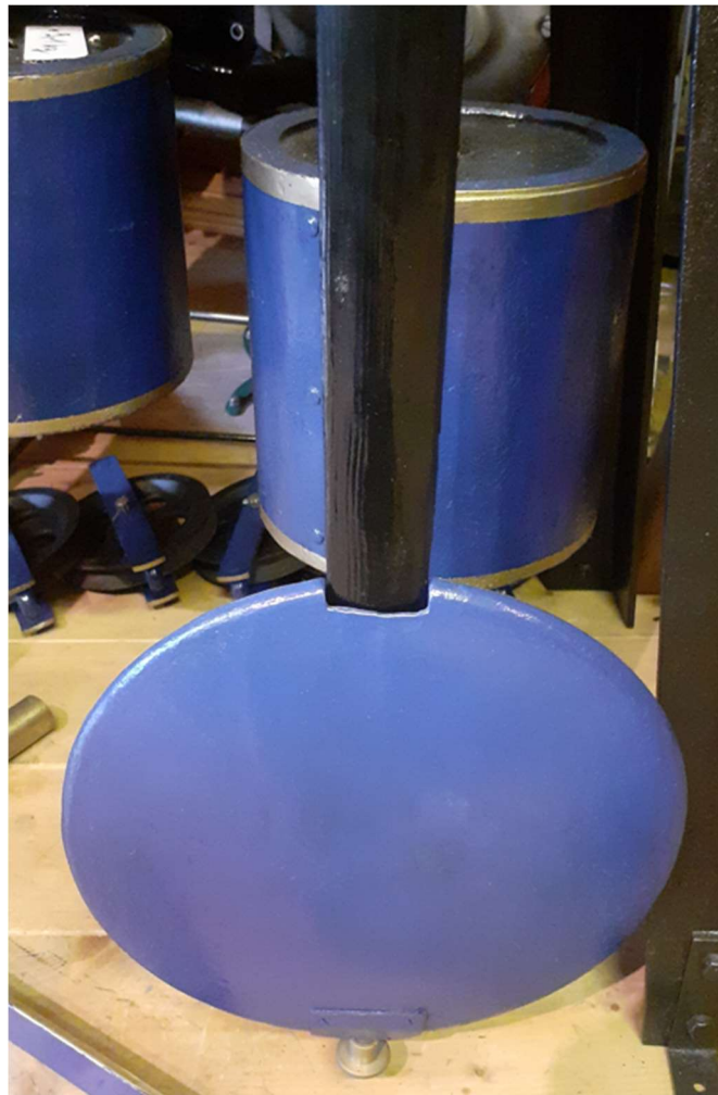
Abbildung 434: Turmuhr Max Hahn, Pendellinse, Gewichte
