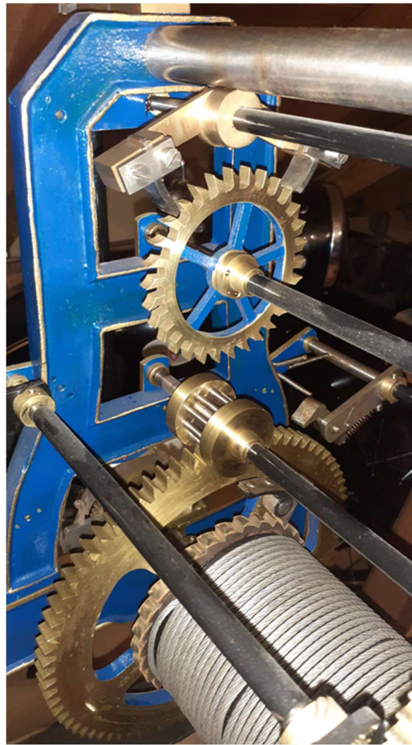
Abbildung 429: Turmuhr Max Hahn, Gehwerk, Graham-Hemmung
