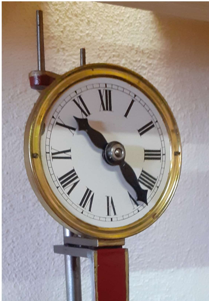
Abbildung 336: Turmuhr Hörz, Kontrollzifferblatt
