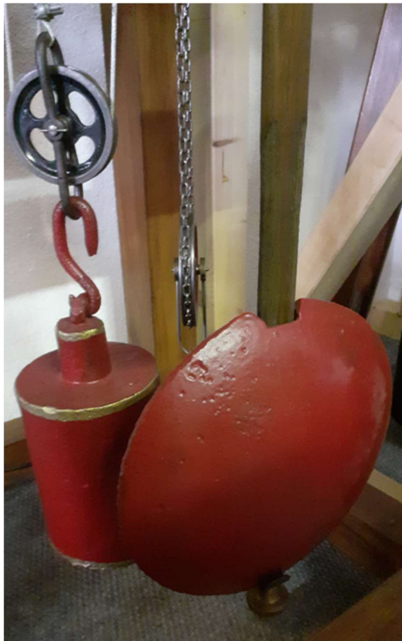
Abbildung 344: Turmuhr Hörz, Gewicht, Pendellinse
