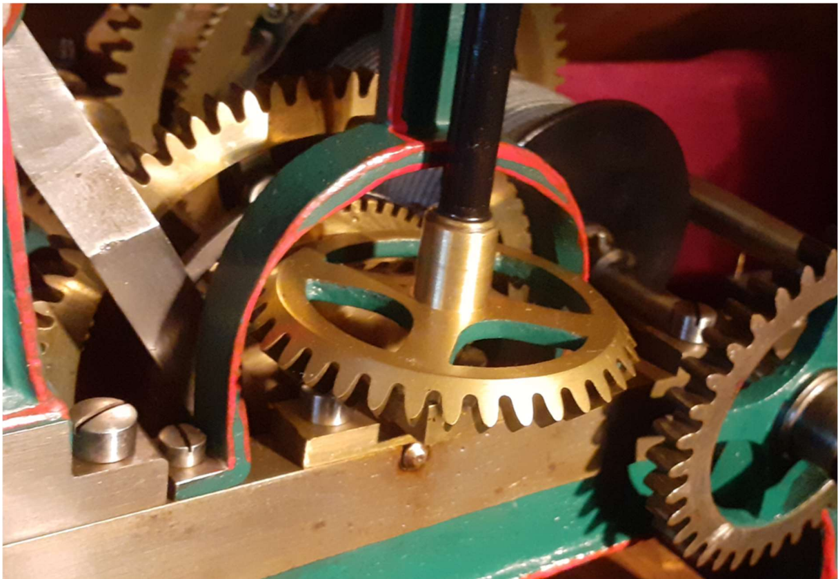
Abbildung 313: Turmuhr Zachariä, Gehwerk, Zeigerwelle
