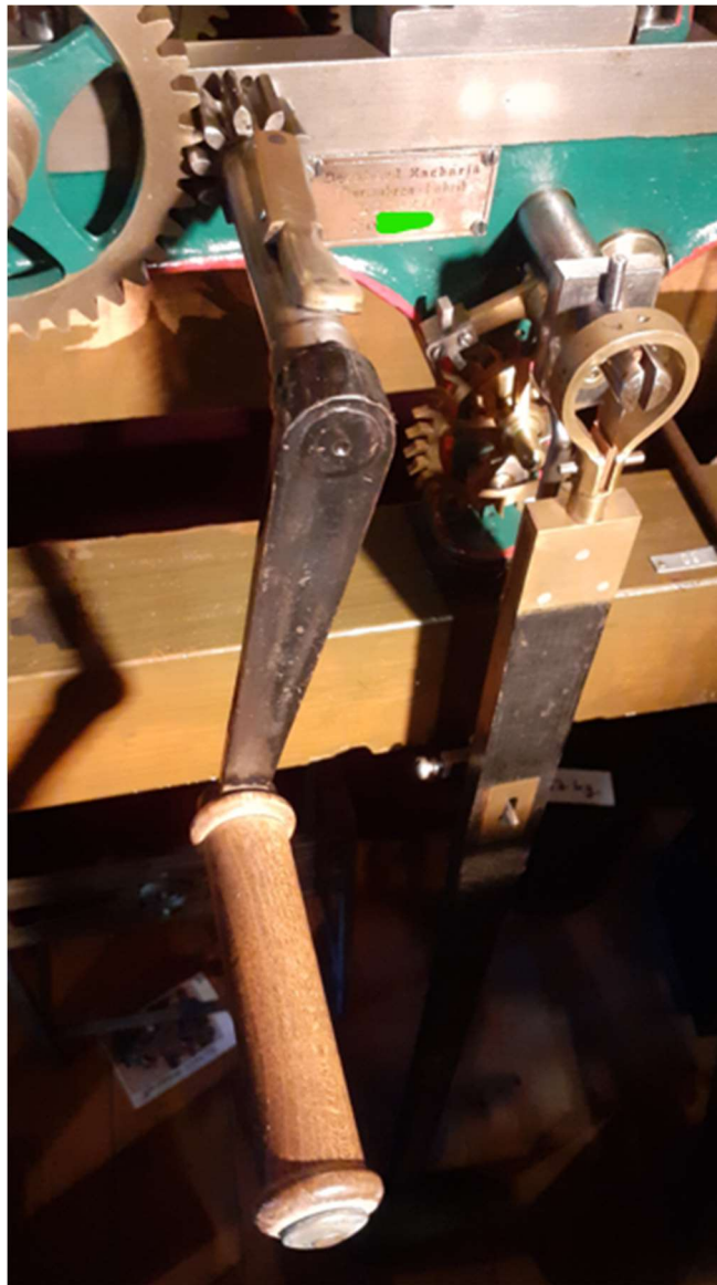
Abbildung 311: Turmuhr Zachariä, Aufzugskurbel mit Zahnrad
