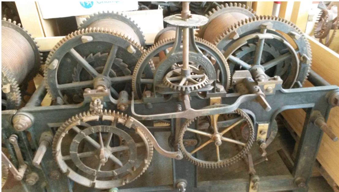
Abbildung 113: Turmuhr Mannhardt, Uhrwerk mit zwei Schlagwerken
