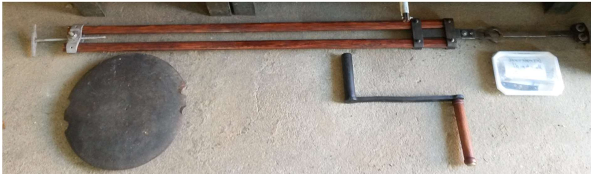
Abbildung 116: Turmuhr Mannhardt, Pendelstange, Pendellinse und Kurbel
