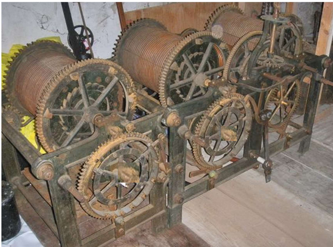
Abbildung 114: Turmuhr Mannhardt, Uhrwerk mit Schlagwerken und Nachschlagewerk
