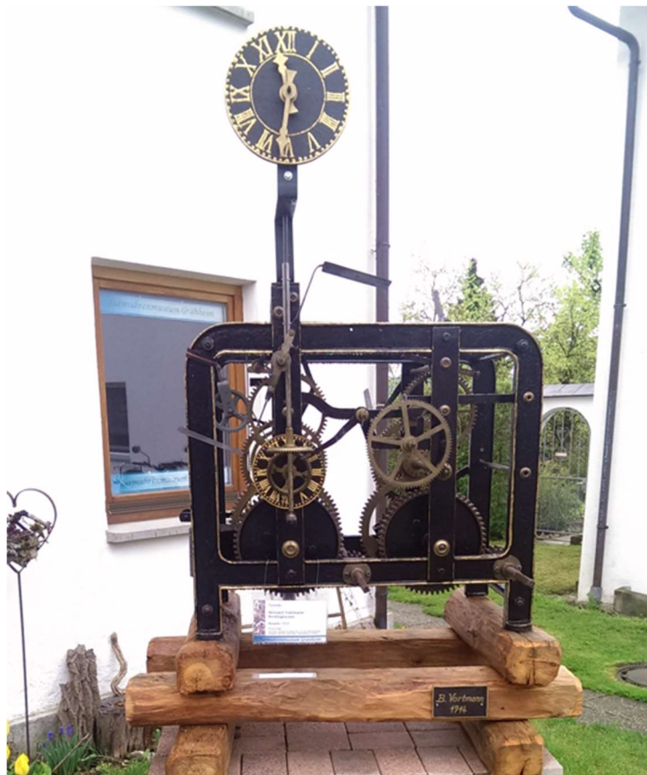
Abbildung 64: Turmuhr Vortmann, noch ohne Pendel und Gewichte
