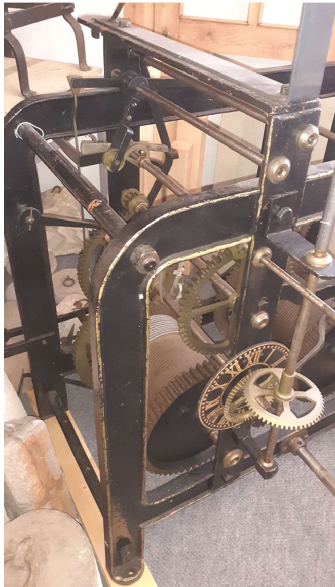
Abbildung 73: Turmuhr Vortmann, Gehwerk, Zeigerleitung
