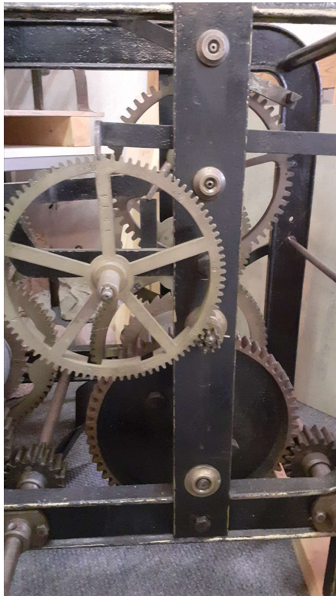
Abbildung 77: Turmuhr Vortmann, Schlagwerk
