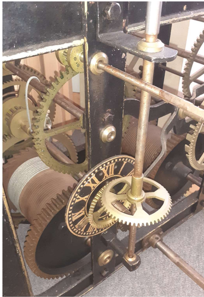
Abbildung 67: Turmuhr Vortmann, Kontrollzifferblatt, Zeigerleitung
