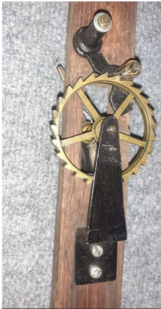
Abbildung 69: Turmuhr Vortmann, Mechanismus Freischwingerpendel
