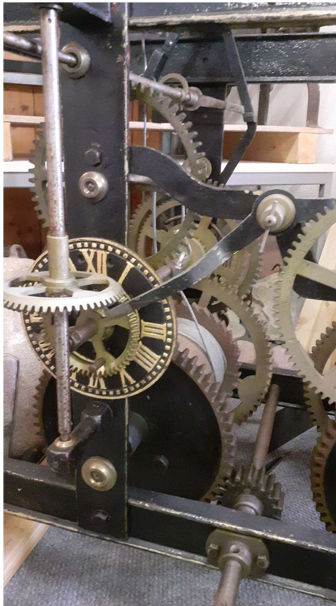
Abbildung 72: Turmuhr Vortmann, Gehwerk
