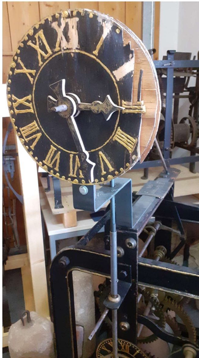
Abbildung 68: Turmuhr Vortmann, nachträglich angebautes Kontrollzifferblatt, Zeigerleitung
