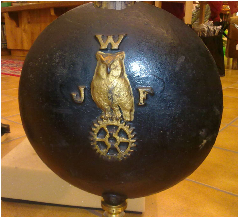
Abbildung 15: Turmuhr Weule, Pendellinse
